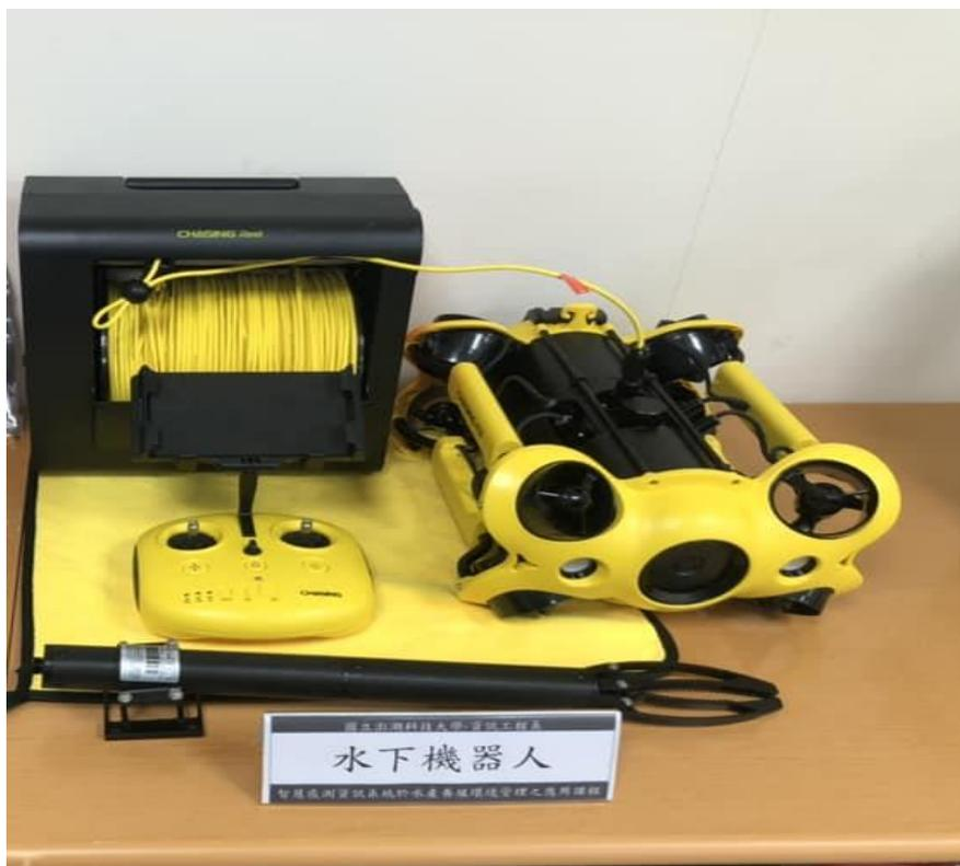
圖 5、Under water robot.
