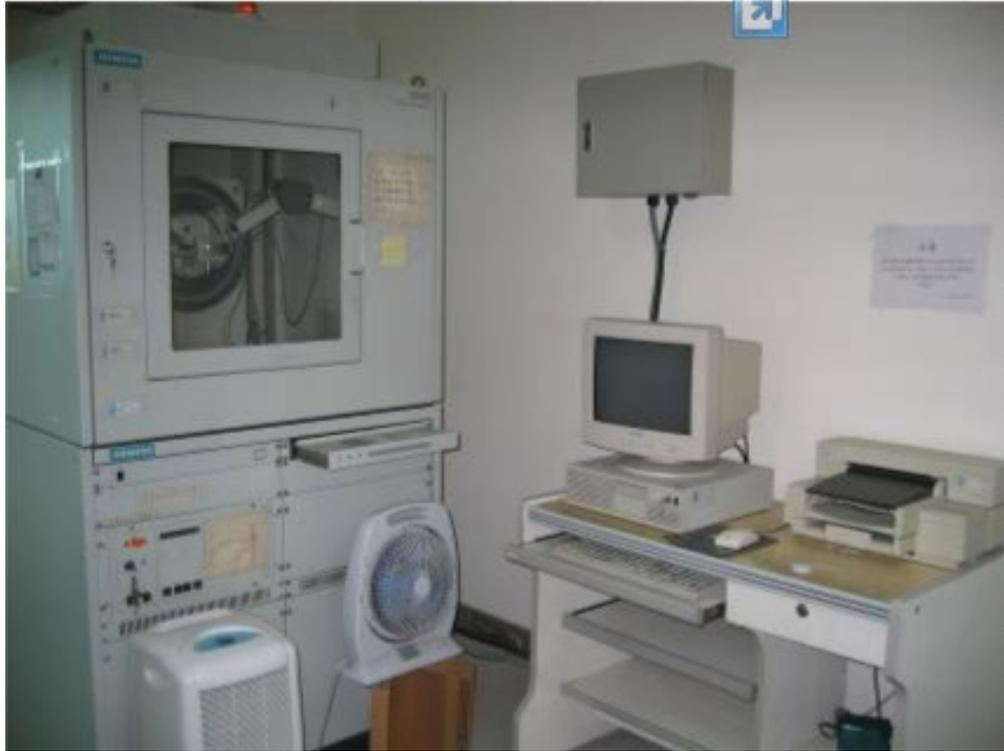
圖 7 PANalytical X'PERT PRO X-ray 繞射分析儀
