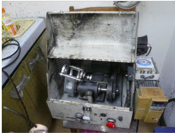
圖 5 SPEX 8000D mixer mill 型高能量震動式球磨機
