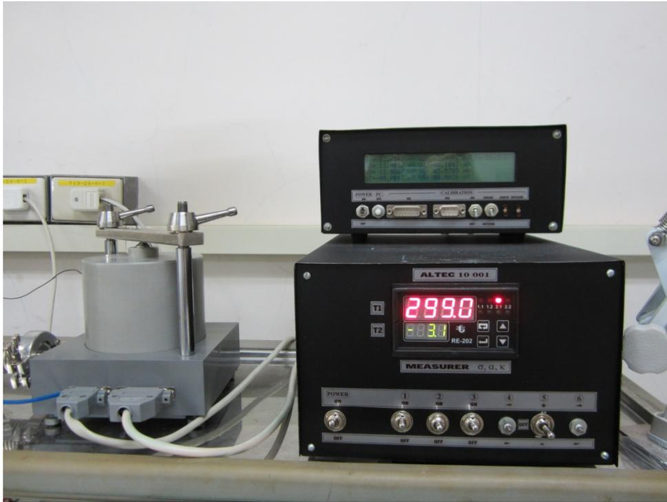
圖 10 熱電量測之 ITE 設備外觀圖(型號 ALTEC-10001)。
