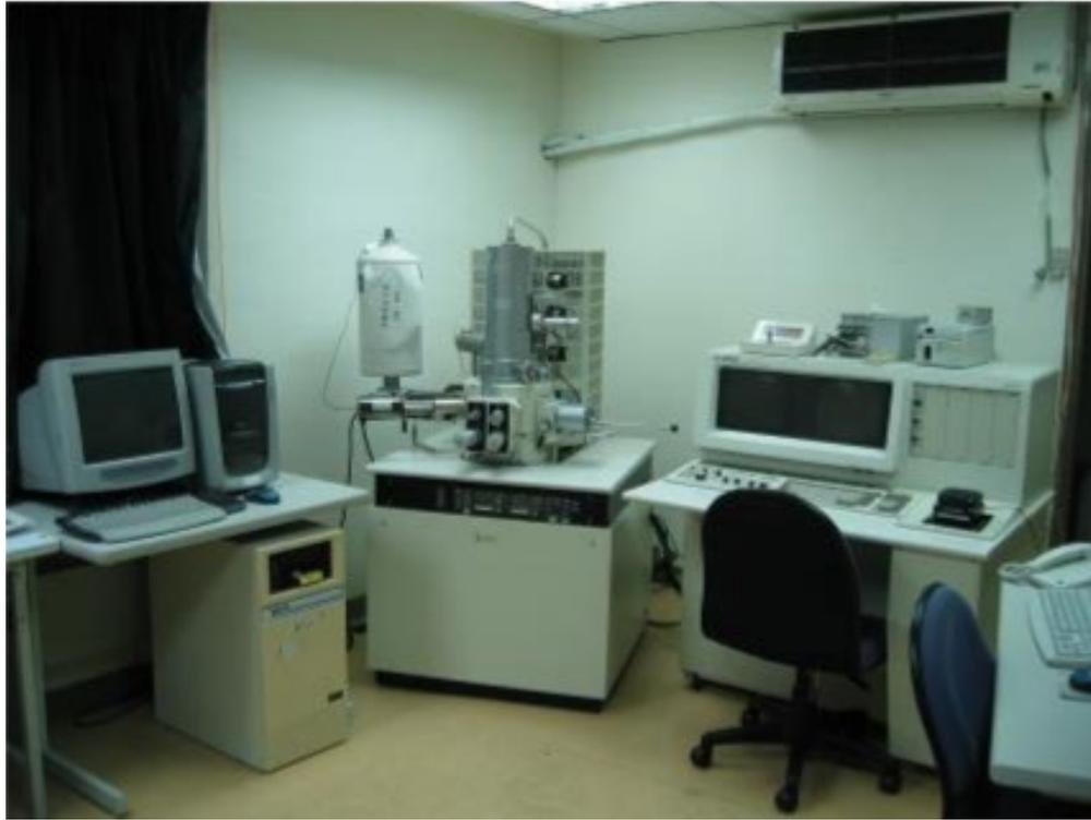
圖 8 Hitachi S-4800 型掃描式電子顯微鏡
