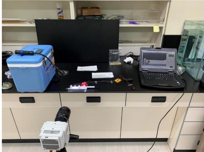
圖 3-3.2 烏賊卵衝擊模擬實驗設備架設圖。架設完衝擊模擬機構後，透過高速攝影紀錄烏賊卵受到尖頭及平頭的撞針的形狀改變。
