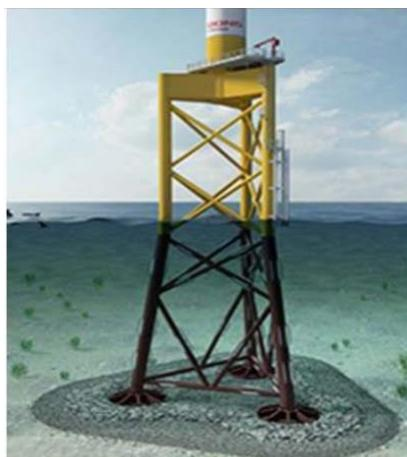
圖 2. 基樁式發電系統示意圖[4]
