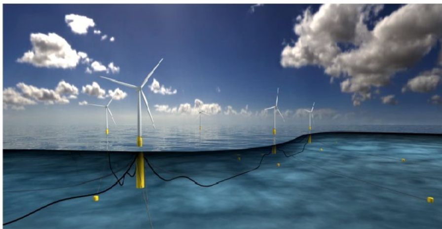
圖二、Hywind 風場結構示意圖（資料來源：Equinor）
