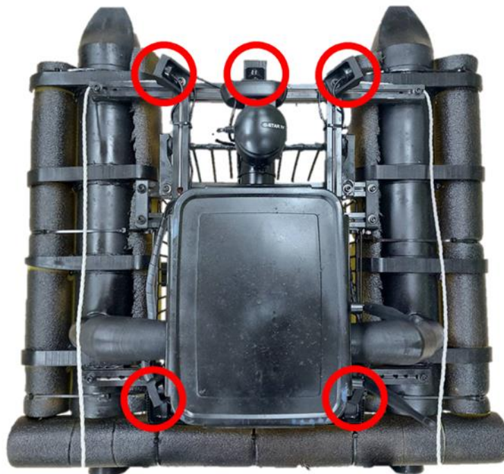
圖 22、超音波測距模組安裝位置
