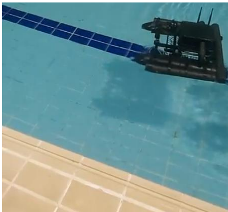
圖 32、船體靠近沿岸準備觸發循岸功能
