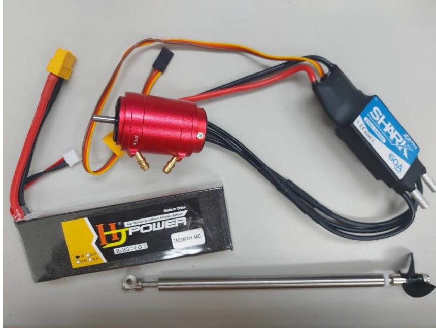
圖 19、動力驅動模組(鋰電池、無刷馬達、電子變速器與船軸)
