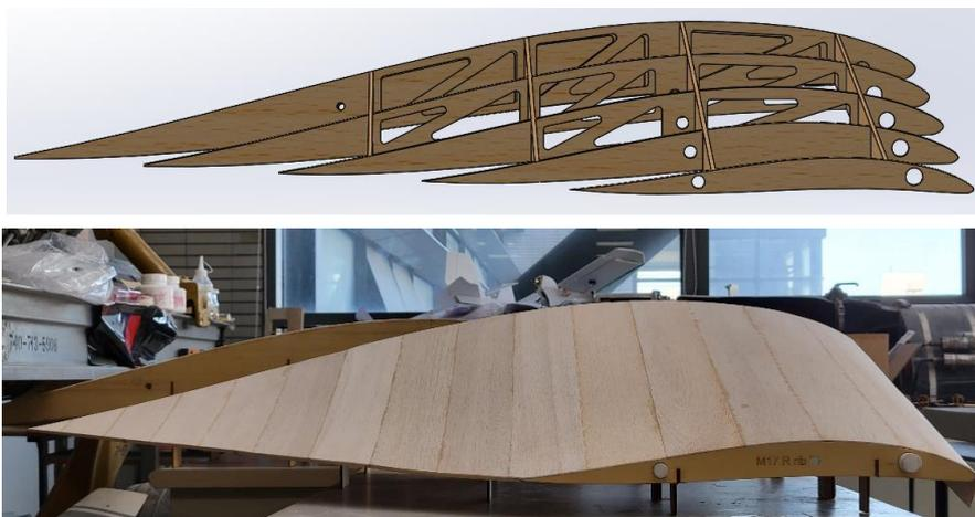
圖 112 主翼結構扭轉角：(上)SOLIDWORKS 結構示意圖(下)主翼實機模型
