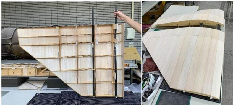
圖 111 主翼結構；(左)內部結構及碳管(右)主翼上蒙皮外觀
