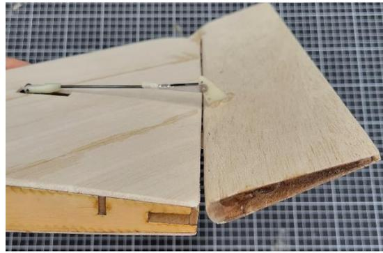
圖 117 副翼舵面作動測試
