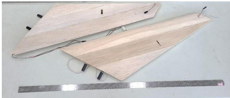
圖 121 垂直尾翼外觀：圖中直尺長度為 100cm
