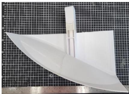
圖 122 前艙門內側：此處將填充發泡材料
