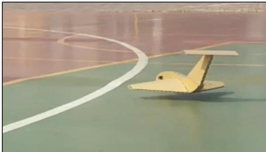
圖 13 模型於翼地效應下的飛行姿態與高度
