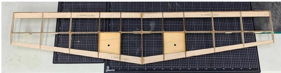
圖 118 水平尾翼內部結構
