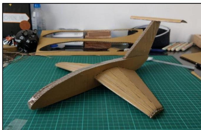
圖 11 自製倒三角翼翼地效應機模型
