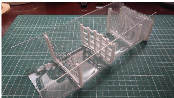
圖 78 過濾網回收裝置簡易模型
