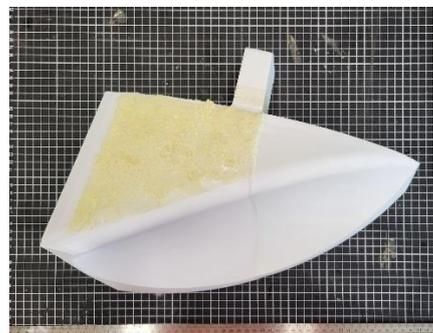
圖 123 前艙門外觀：黃色部分為發泡劑填縫造成
