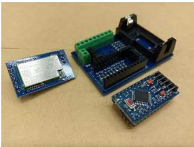
圖3-2：LoRa發射器(零件分解圖)
