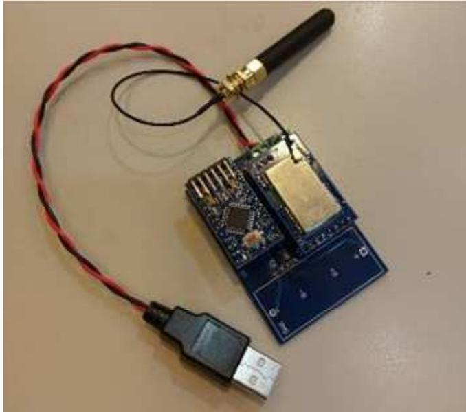
圖3-6： LoRa發射器用於監測水質之無線感測(遠距離)
