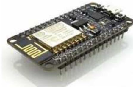
圖2-2： ESP-8266控制器
