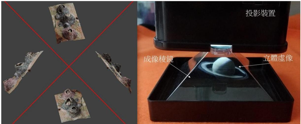
圖 三十六、全息投影裝置示意圖，右圖之投影裝置可以使用智慧型手機或平板取代，有了 3D 模型即可簡單製作投影所需之四分割圖檔或影片(左)
