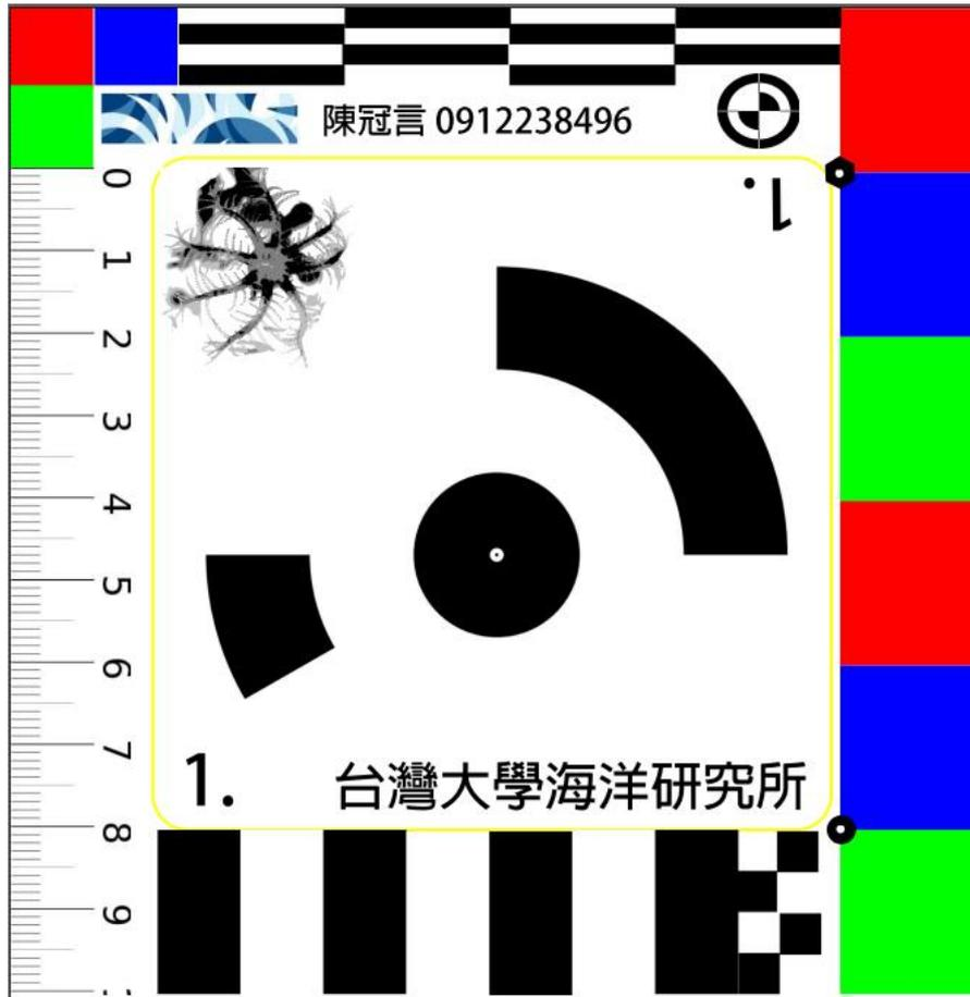
圖 十三、地面控制點設計圖(使用 Adobe illustrator 製作)
