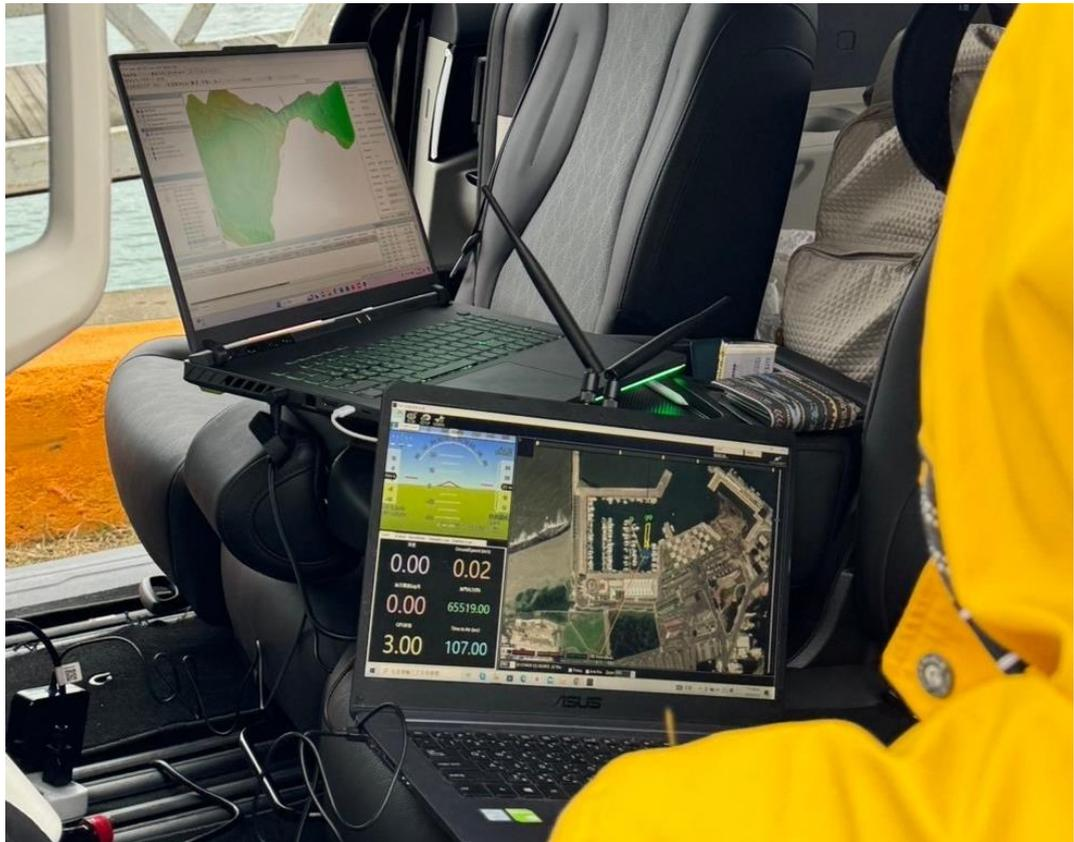
圖2-7:電腦即時監測無人船水深測量作業。
