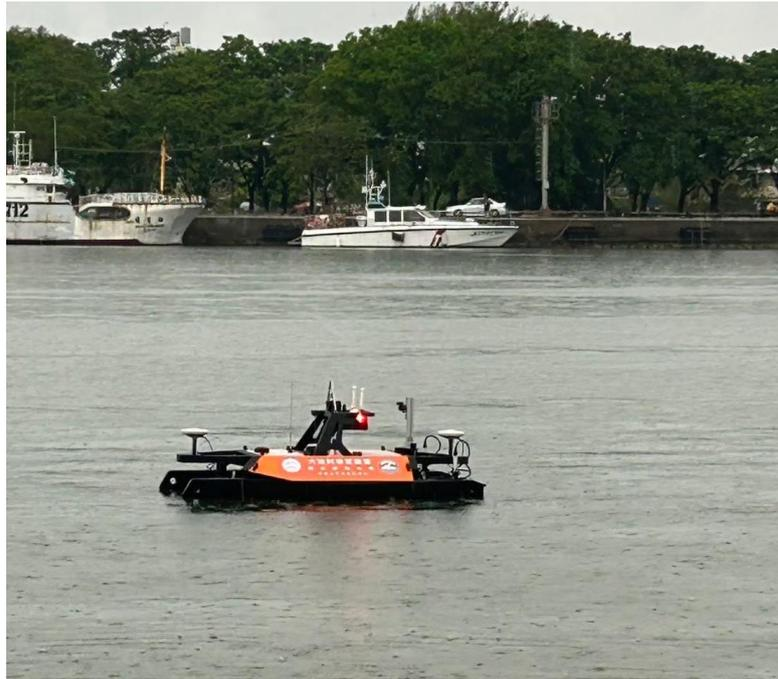
圖2-2:於安平港使用Otter Pro進行測深測試作業。
