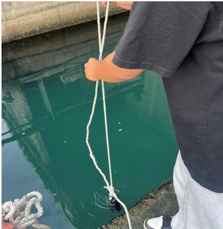
圖2-5: 投放NORBIT聲速剖面儀。
