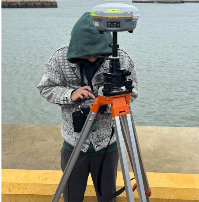
圖2-4: 架設GNSS接收儀。
