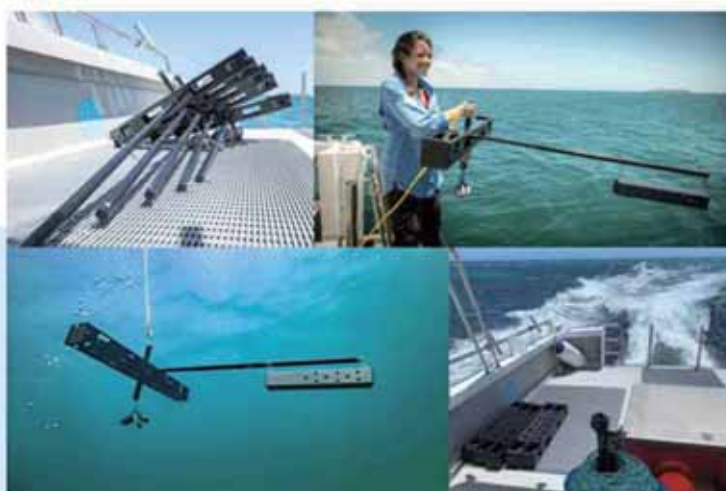
圖3／誘餌式遠端水下攝影系統布放示意圖
