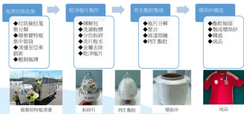
圖說／海廢寶特瓶回收再製流程圖 資料來源／亞東創新公司
