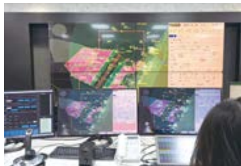
船舶交通服務系統 (VTS) 資料來源：交通部
