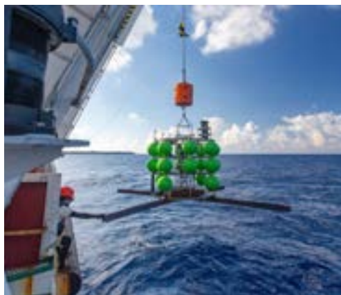
底碇式海流儀錨碇布放
