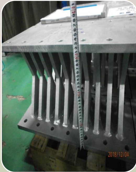
X字型鋼板 加勁阻尼器 (X型制震板)
