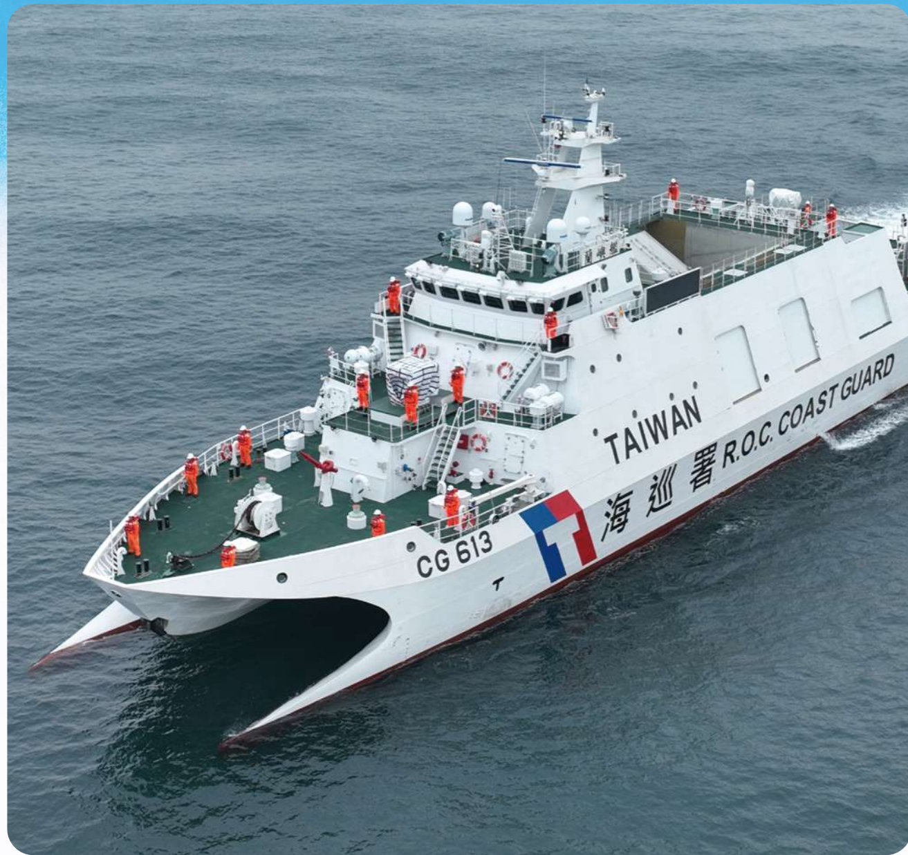
圖 1 蘭嶼艦全長約 65 公尺、寬約 14.8 公尺，最高航速可達 40 節，續航力約 2,000 浬。圖片來源：海洋委員會
