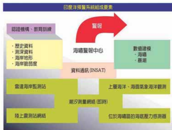
圖2／印度洋海嘯預警系統 (TEWS) 作業方式 圖片來源／[1]
