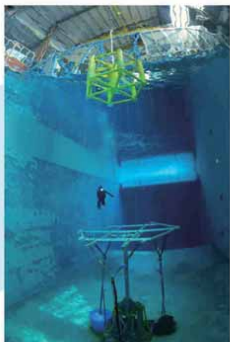
圖2/Ifremer在深水試驗池中測試浮動式風機平臺 圖片提供/Ifremer/ O.Dugornay
