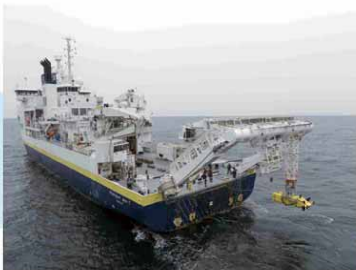
圖3/AUV 6000 Ulyx從R/V Pourquoi Pas下水Ulyx可潛水至6,000公尺深， 自主完成長達48小時的任務 圖片提供/Ifremer, S. Lesbats (2022)
