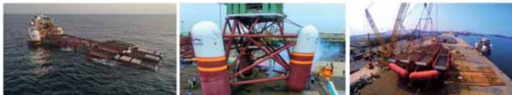
圖2／浮臺式發電機實海船拖測試 圖片提供／國家海洋研究院
